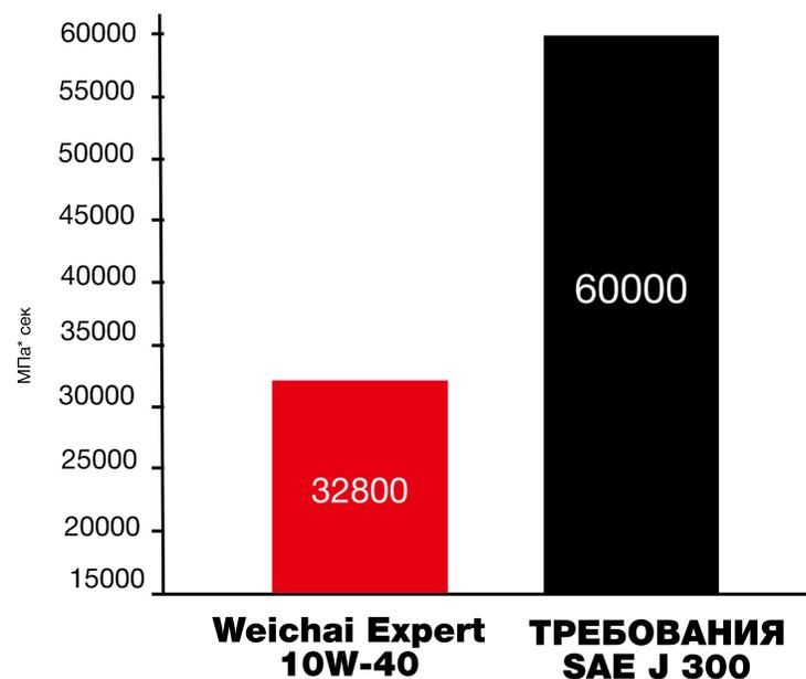
На **45 %** безопаснее запуск холодного двигателя при -30 °C в сравнении с требованиями SAE J300.
